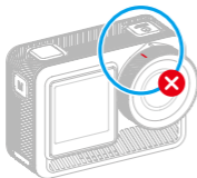
Objektivdeckel unsicher geschlossen
